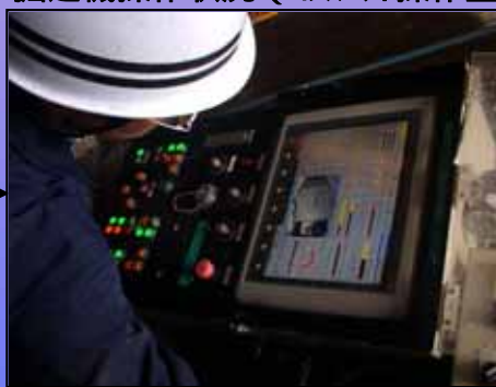
掘進機操作状況（コバ外操作盤）
