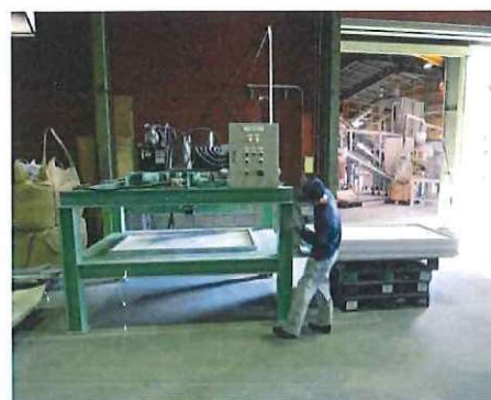
図表 30 アルミフレーム枠外し機
