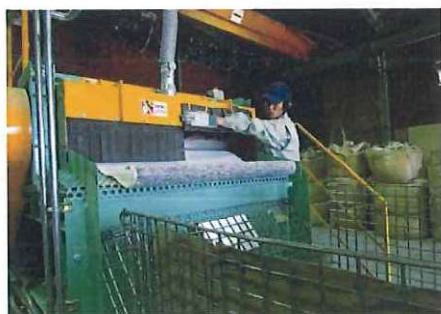
図表 31 破碎機での破碎の様子
